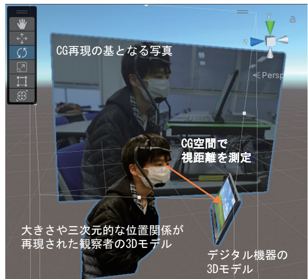
図1 CGによる三次元空間を利用した視距離の測定
